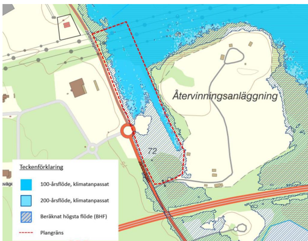
Figur 25. Karta som visar vattnets utbredning i Jädraån (befintlig situation) vid 100- och 200-årsflöde samt BHF. Källa: Bjerking 2022-04-08.
